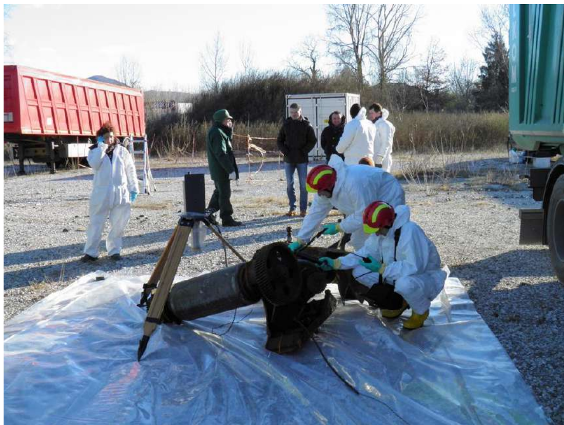
Figura 11: Rinvenimento di una sorgente orfana in un carico di rottami metallici (ARPA Friuli - Venezia Giulia)
